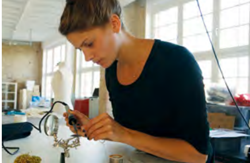
Auf Kurs: Designerin Lina Wassong beim Lötens eines Kompass-Sensors, der – in ein Kleidungsstück integriert – Geschwindigkeit und Bewegungsrichtung des Trägers anzeigen soll
