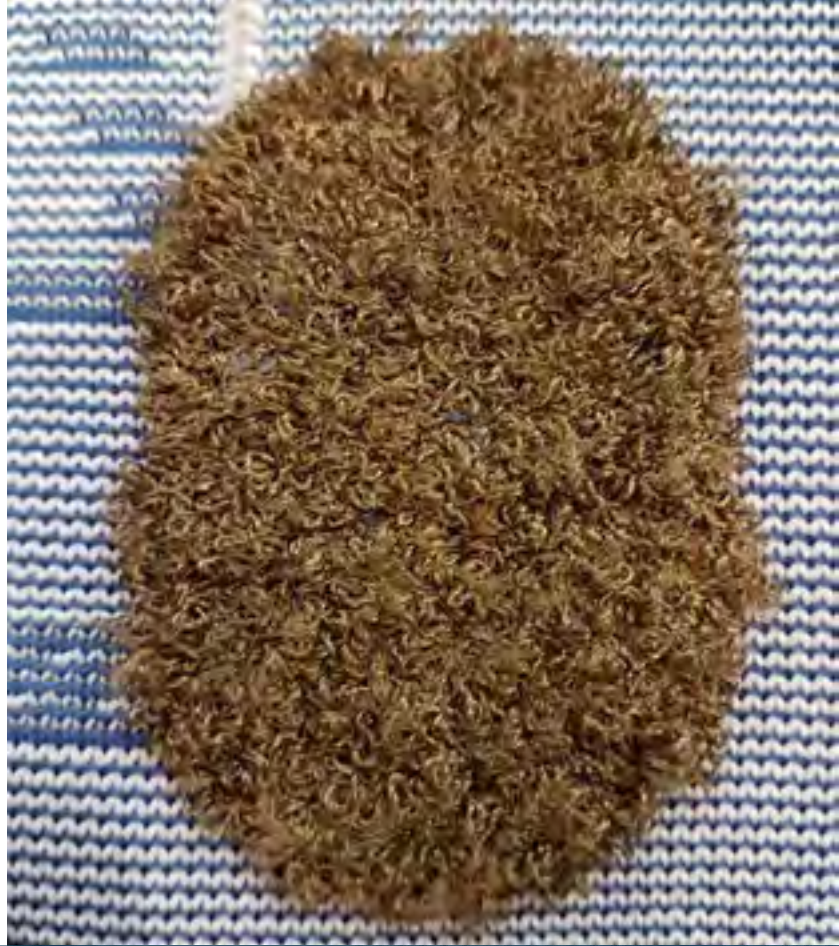
Moosgestrickte Elektroden aus silberbeschichtetem Garn: Das ITA erforscht und entwickelt seit Jahren textile Elektroden
