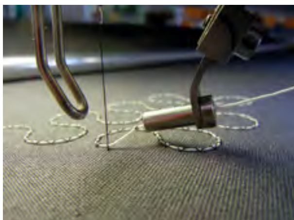
Sticktechnologische Applikation des funktionalisierten E-thread®-Fadens mit LED
