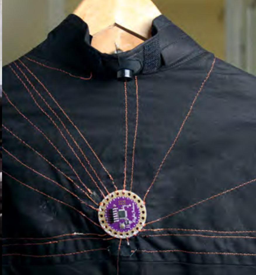
Am leitenden Faden: Rückenteil einer smarten Jacke mit aufgenähtem Mikroprozessor – gut zu erkennen sind die leitfähigen Kupferfäden
